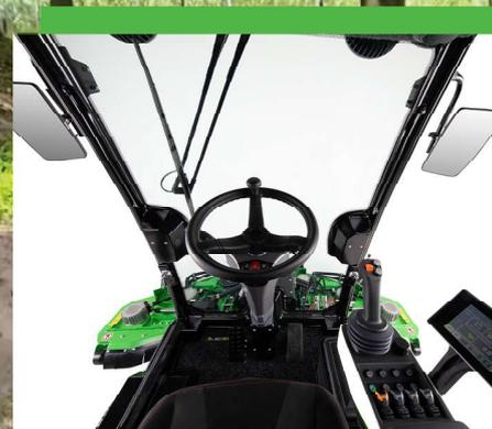
Le 8015F peut être équipé d'un cadre **ROPS** ou d'une **cabine**.
